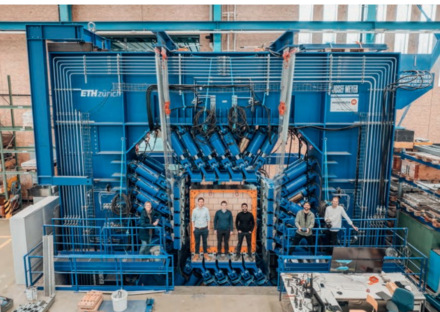
Am Campus Hönggerberg der ETH Zürich finden Versuche am «Large Universal Shell Element Tester», kurz LUSET, statt. Der LUSET wird seinem Namen gerecht: Er ist gross. Sehr gross sogar ...
