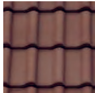
Pfannenziegel Lattweite: ca. 35 – 36 cm Deckbreite: ca. 21 – 22 cm Ziegelbedarf: ca. 13 – 14 Stk./m 2
