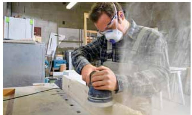
**Bild 5:** FFP2-Maske beim Schleifen von Holz. Bei Holzstaub von Buche oder Eiche ist immer FFP3 resp. P3 zu benutzen.
