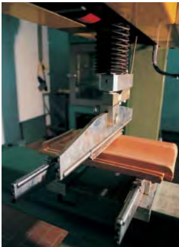
Laborversuch im p+f Sursee zur Überprüfung der Biegefestigkeit der Dachziegel.
