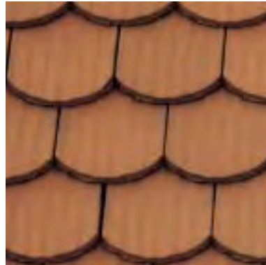
Grossflächen-Biberschwanzziegel Lattweite: ca. 20 cm Deckbreite: ca. 25 – 26 cm Ziegelbedarf: ca. 20 Stk./m 2
