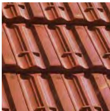
Bergmuldenziegel Lattweite: ca. 35 cm Deckbreite: ca. 21 cm Ziegelbedarf: ca. 14 Stk./m 2
