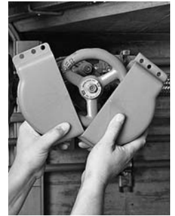
Bild 3: Absperrung für Ventil
