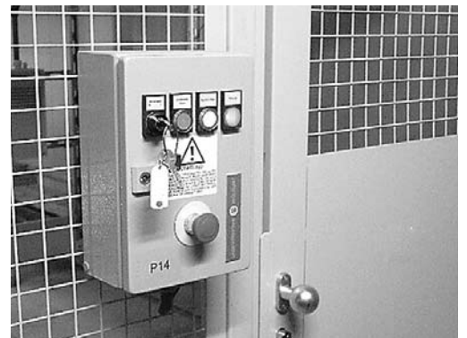
Bild 5: Die Drucktaster sind mit Kragen ausgestattet, die ein unbeabsichtigtes Betätigen verhindern.
